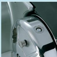
Il sistema automatico di caduta libera della catena permette di calare l'ancora premendo semplicemente per un istante il comando elettrico di discesa evitando ogni altra operazione manuale. L'arresto della catena avviene azionando il comando elettrico di salita. E' possibile disinserire manualmente il sistema Free-Fall per un completo controllo manuale della caduta della catena.
