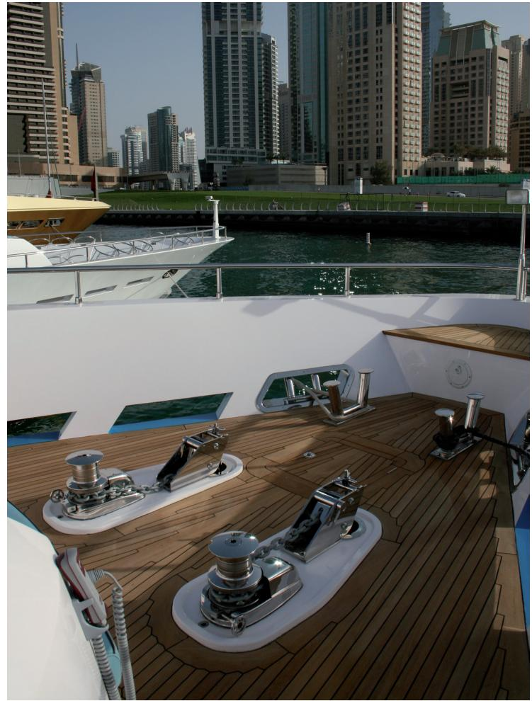
La serie DUKE è una linea di salpa ancora verticali per imbarcazioni da 18 a 30 metri circa. I diversi modelli, denominati DK6, sono proposti con motori elettrici in corrente continua (DC 3000-3500 W) o corrente alternata (AC 4000-5500 W). Nella gamma è disponibile anche il modello con motore idraulico DK6 Hydro.
