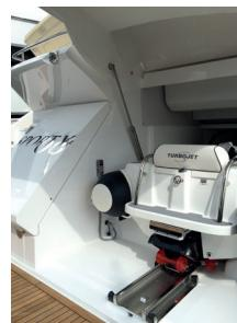
Il verricello TMG è dotato di **riduttore epicicloidale** che permette di sfruttare al meglio la potenza del motore (risparmio del 40% nell'assorbimento).
