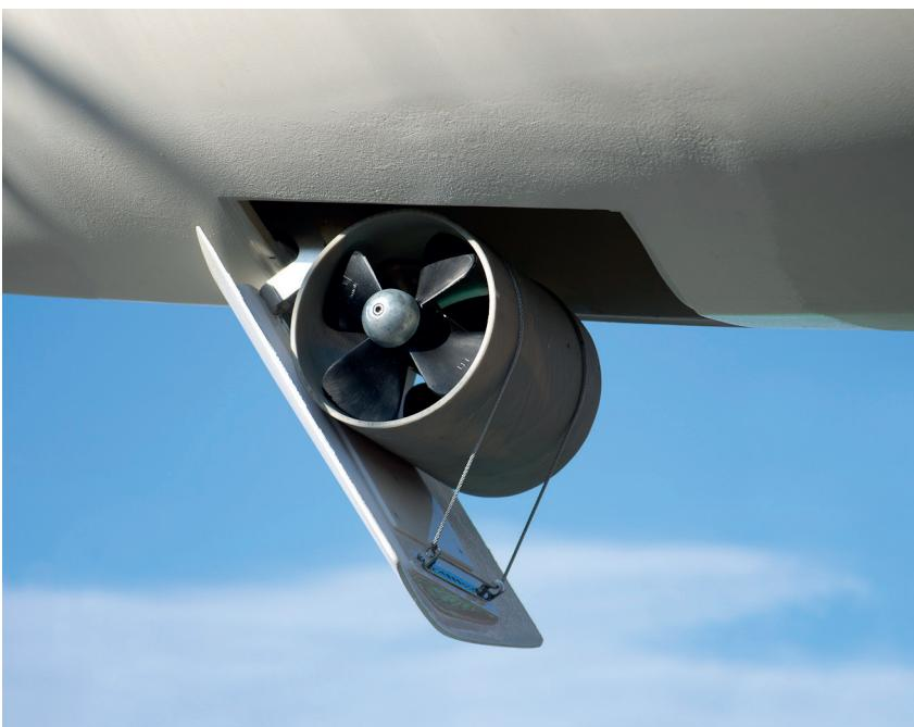
Le eliche retrattili nascono per garantire le medesime prestazioni delle eliche a tunnel, limitando il più possibile la resistenza fluidodinamica dello scafo in navigazione. L'elica viene aperta con la sua attivazione durante l'ormeggio e si retrae alla disattivazione, ricreando perfettamente la geometria dello scafo.
